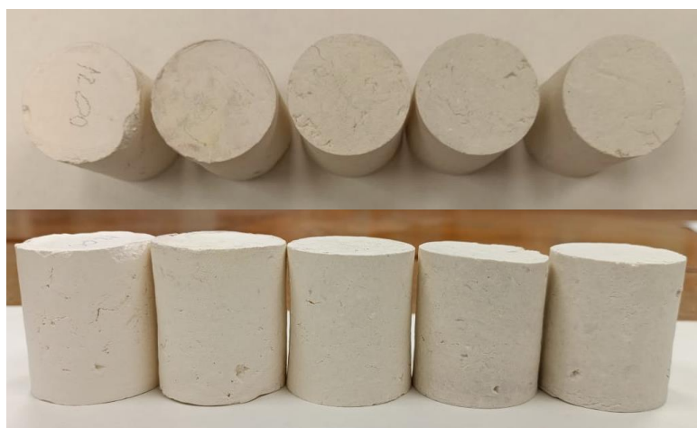
Рисунок 29 – Образцы из обогащенного каолина после обжига при температурах: 1200, 1250, 1300, 1350, 1400 °C соответственно
