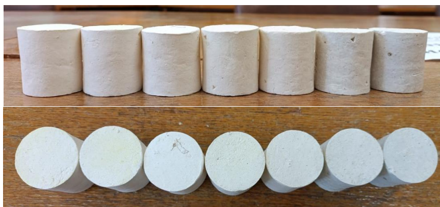
Рисунок 30 – Образцы из сырца после обжига при температурах: 1180, 1200, 1250, 1300, 1350, 1400, 1450 °С соответственно
